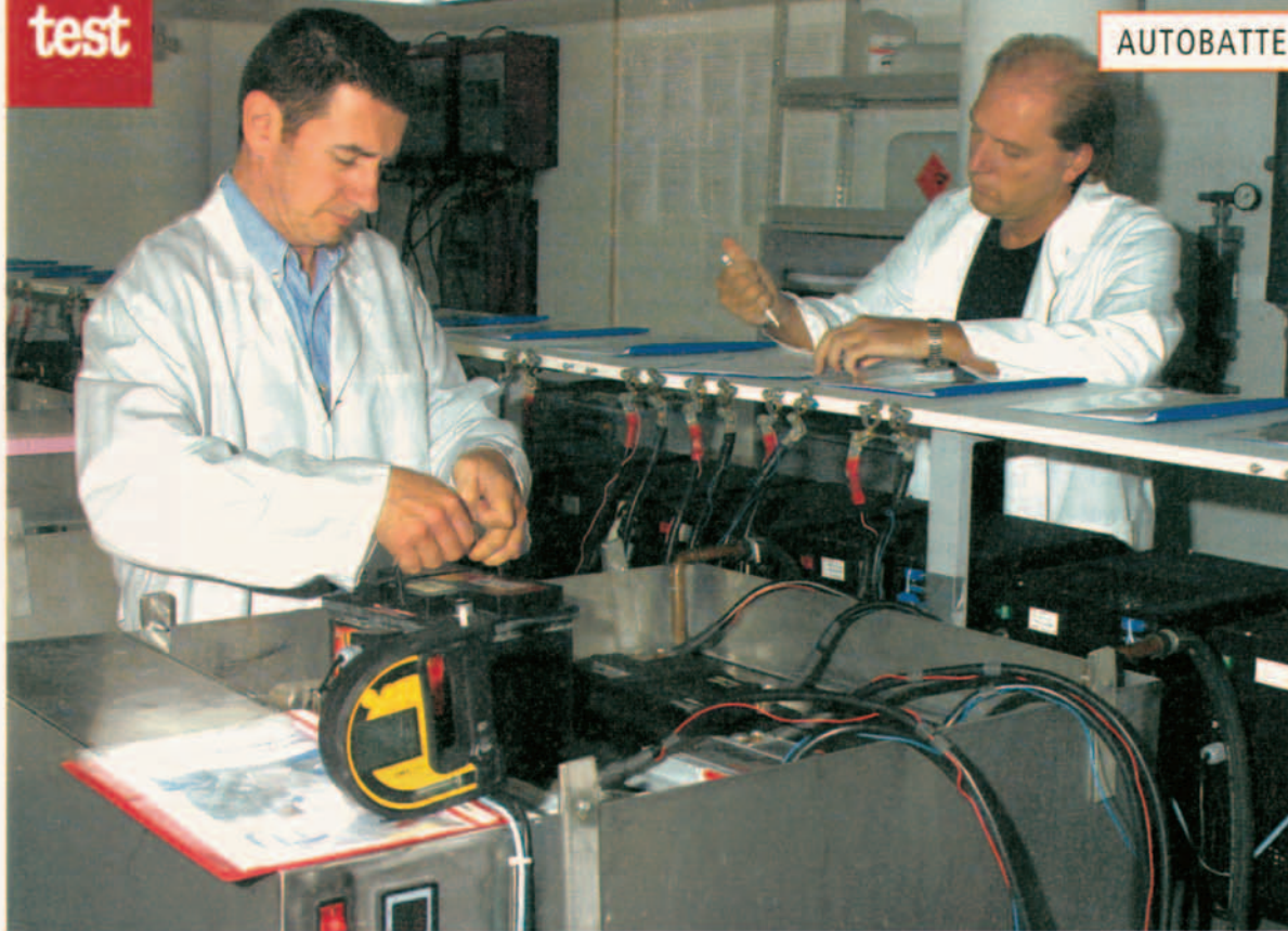
Unten: Programmierung der Lade- und Entladevorgänge.
