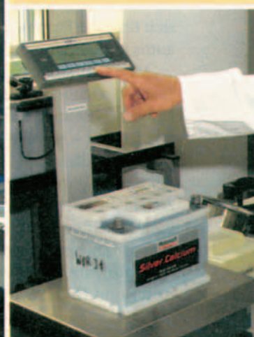
Oben: Der Wasserverlust wird durch Wiegen ermittelt.
